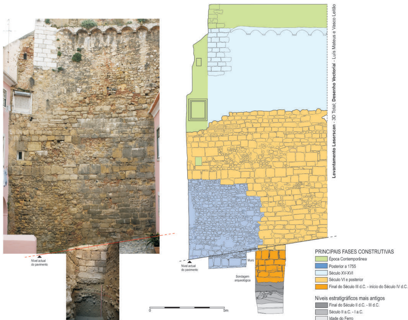
FIG. 4 Rua de S. João da Praça, 18/Pátio da Sr. a de Murça. (PSM 07). Alçado integral da muralha.
