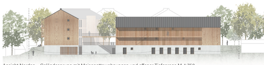
Ansicht Norden – Geländesprung mit Maisonettewohnungen und offener Tiefgarage M. 1:750
